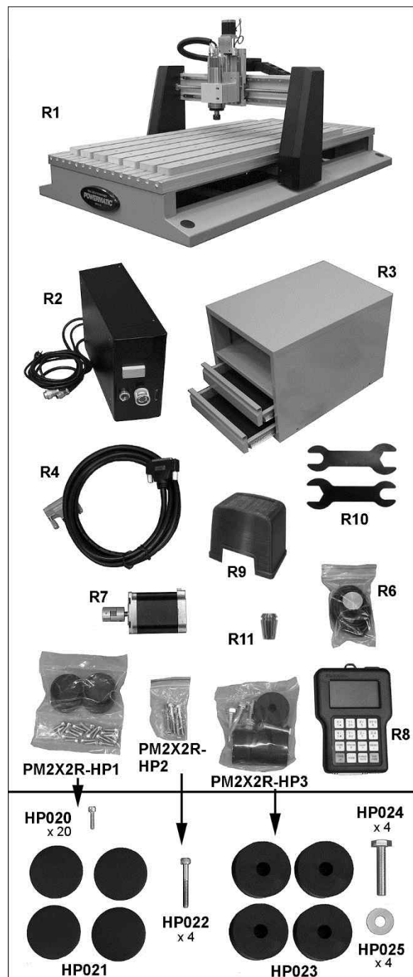
Figure 7-7 : Contenu de l'emballage de la table de la PM-2x4SP (dessin non à l'échelle)
